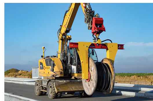
Bis zu 4 t schwere Kabeltrommeln kann der hydraulisch gesteuerte KabelFIX aufnehmen.
